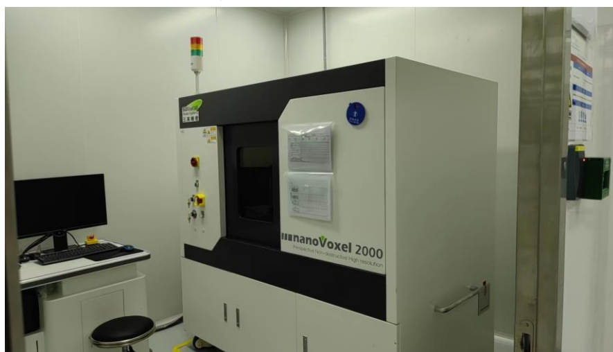
图4-2 工业CT、工作人员操作位、工作指示灯、急停按钮
